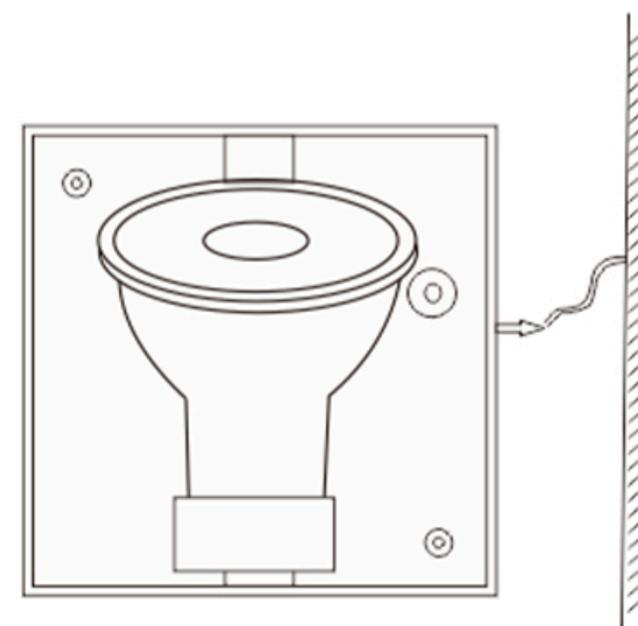
**1. Подключите провода и закрепите корпус настенного светильника на стене**
