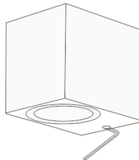
**3. Зафиксируйте винты с помощью небольшого гаечного ключа.**
